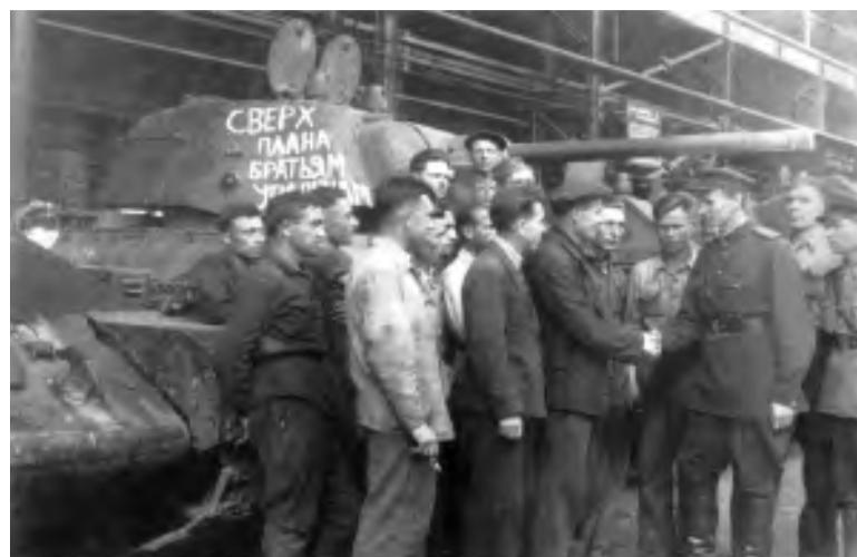
Средние танки Т-34, изготовленные сверхплана для Уральского добровольческого танкового корпуса. Штампованная башня для танка на снимке вытуплена на Уральском заводе тяжелого машиностроения имени Орджоникидзе (УЗТМ) в Свердловске.
